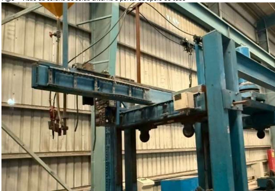
Fig.9 – Visão da coluna de solda externa e portal de apoio do tubo
