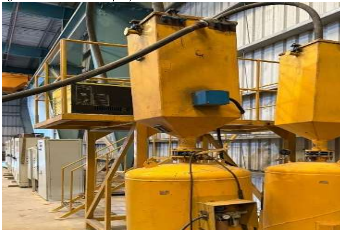
Fig.8 – Visão do sistema de recuperação de fluxo
