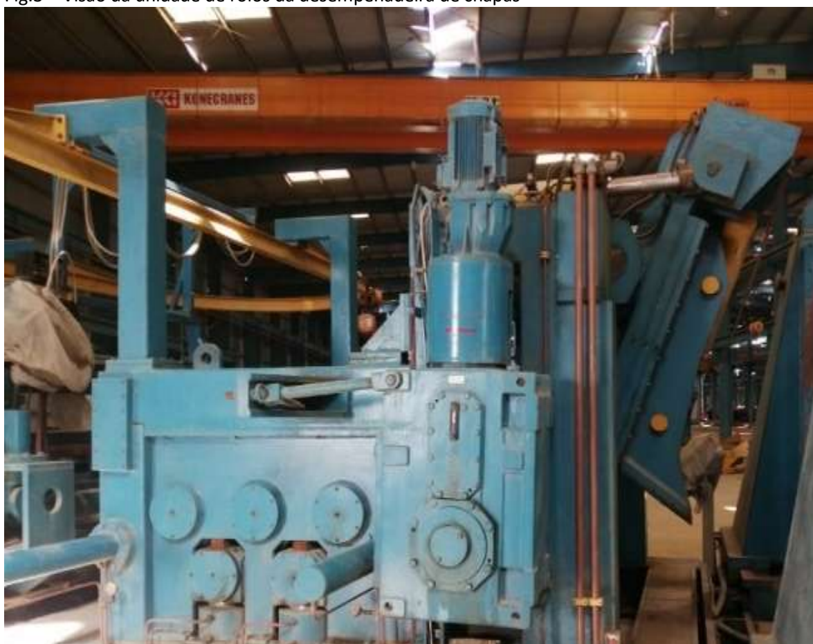
Fig.3 – Visão da unidade de rolos da desempenadeira de chapas
