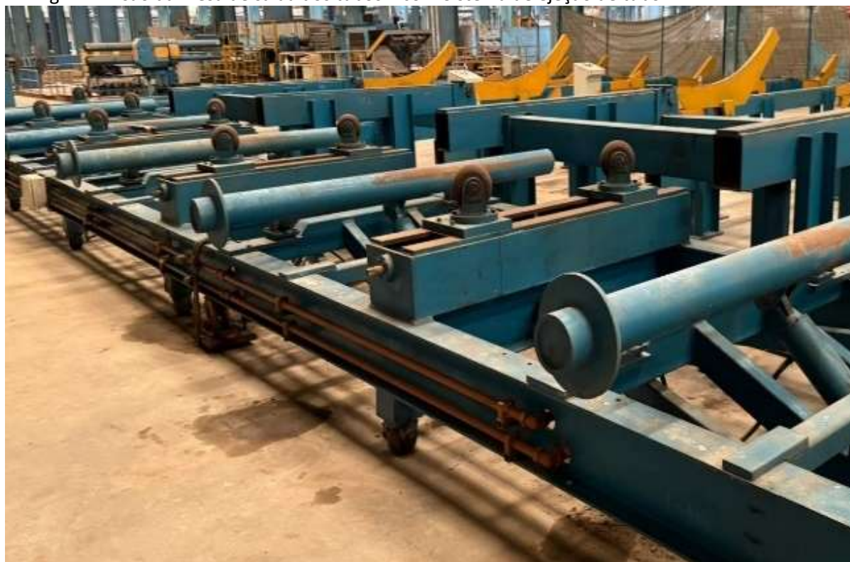
Fig.11 – Visão da mesa de saída dos tubos – com Sistema de ejeção de tubo
