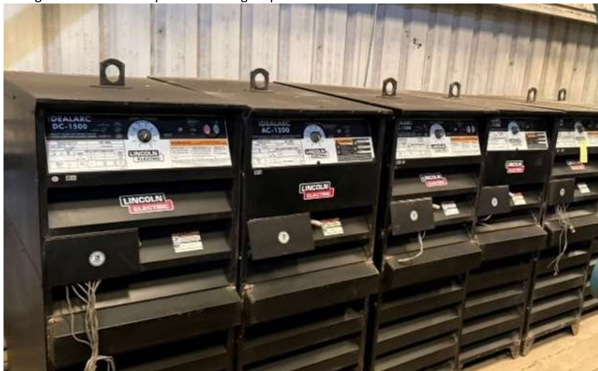
Fig.10 – Visão das máquinas de soldagem por arco submerso Lincoln
