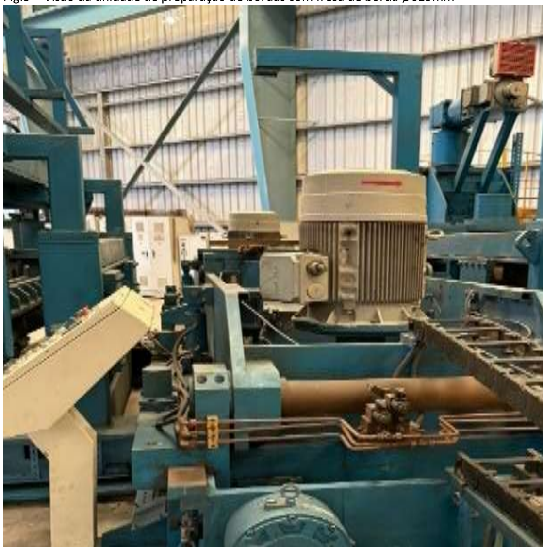
Fig.5 – Visão da unidade de preparação de bordas com fresa de borda Ø615mm
