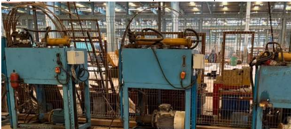
Fig.13 – Visão da unidade de potência hidráulica – para entrada da máquina e mesa de saída
