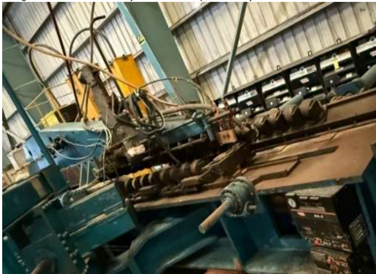
Fig.7 – Visão da mesa de formação de tubos em espiral com braço
