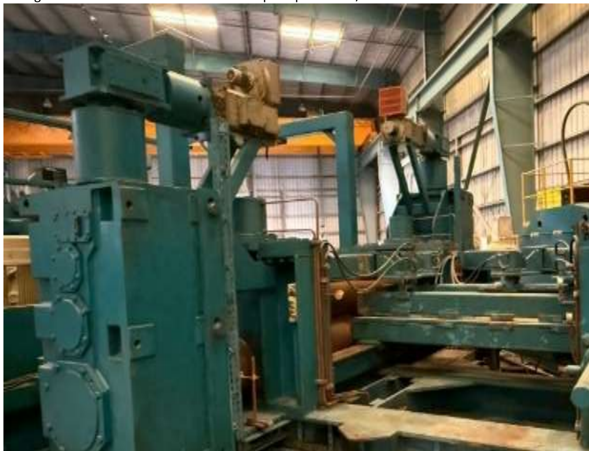
Fig.6 – Visão da unidade de acionamento principal – Rolo Ø450mm
