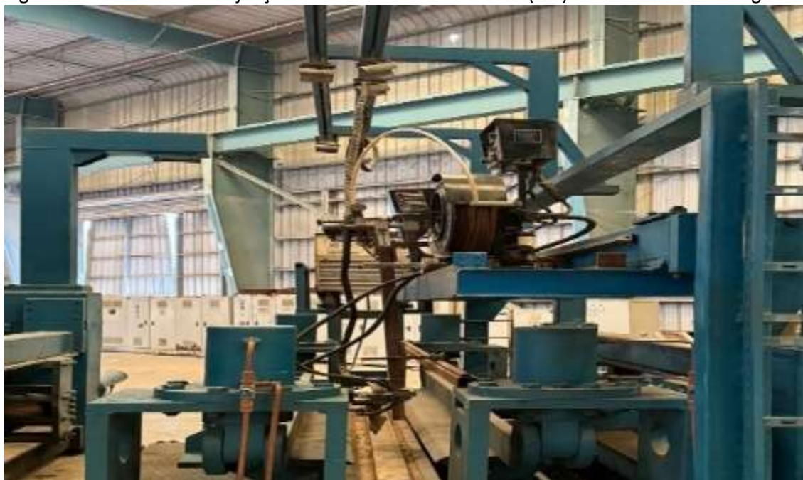
Fig.5 – Visão da unidade de preparação de bordas com fresa de borda Ø615mm
