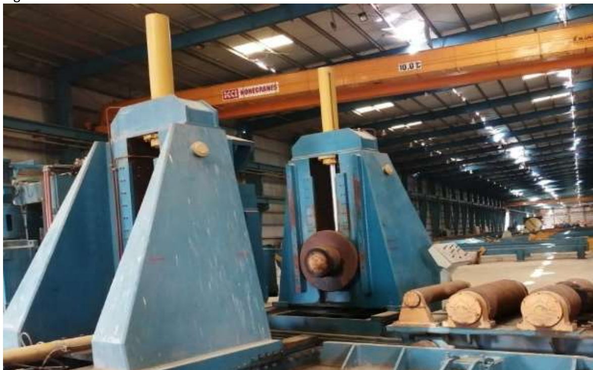
Fig.2 – Visão do módulo de desbobinamento
